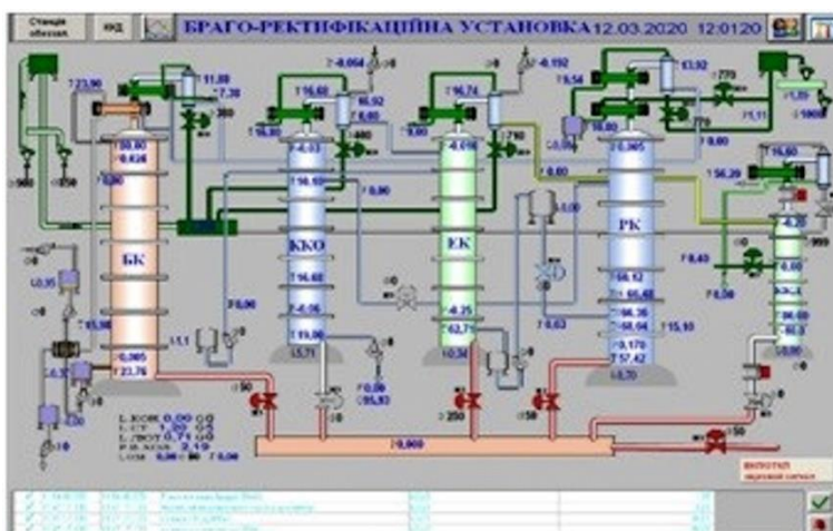
Рис. 2. Экран SCADA/HMI Proficy iFIX для БРУ
