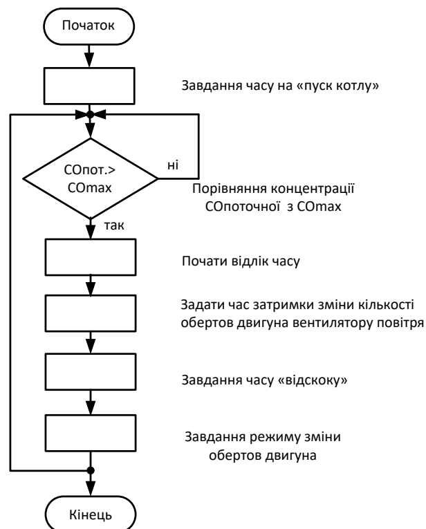
Рис. 3. Блок схема алгоритму «зниження-відскок-підтримка»
