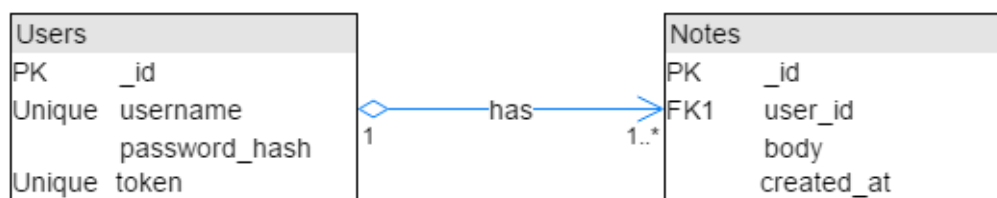
Рис.2. Схема БД в нотації UML
