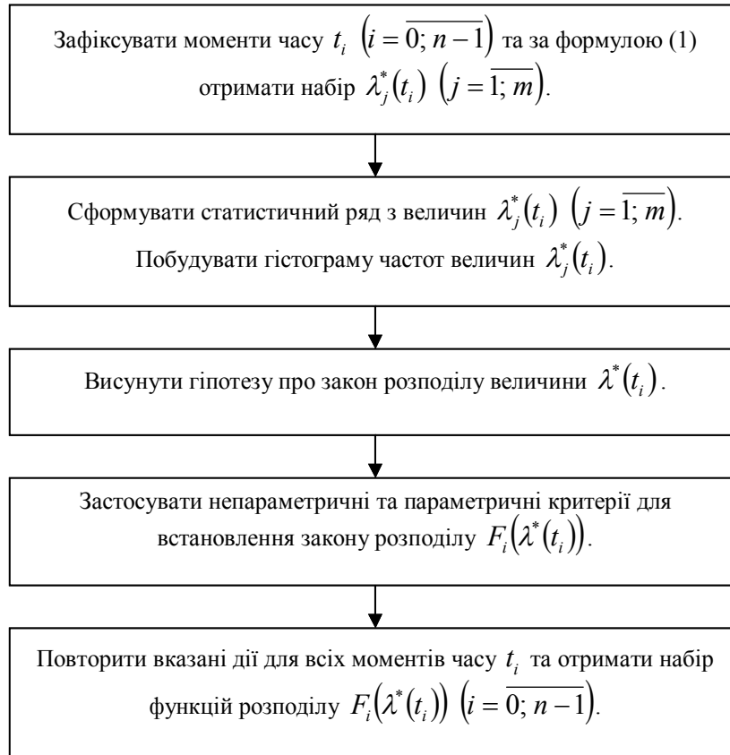
Рис. 1. Схема відшукування законів розподілу інтенсивності відмов сукупності ТС
