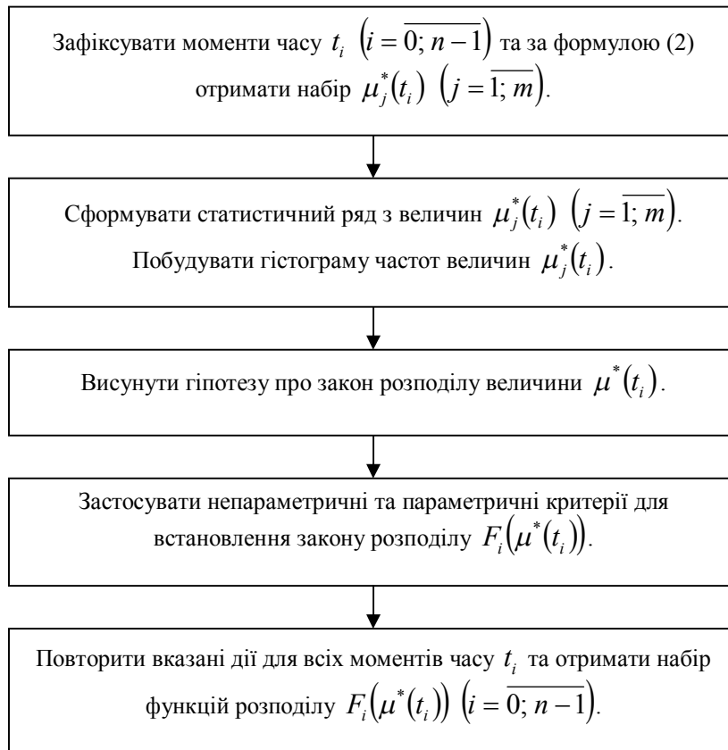
Рис. 2. Схема відшукування законів розподілу інтенсивності відновлень сукупності ТС
