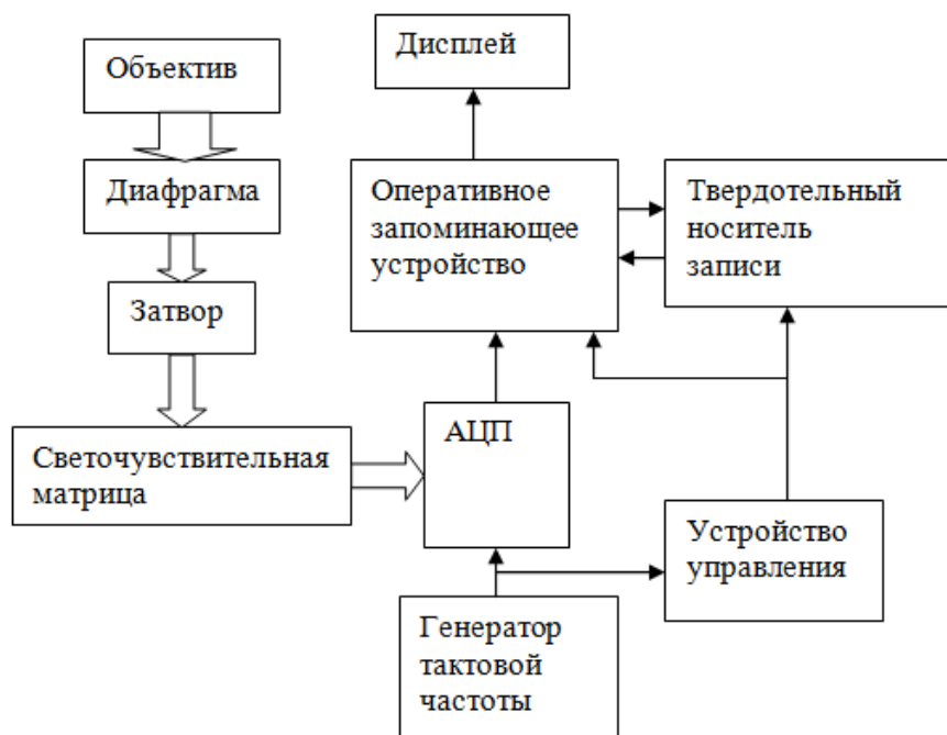
Рис. 1. Функциональная схема цифрового аппарата записи изображений
