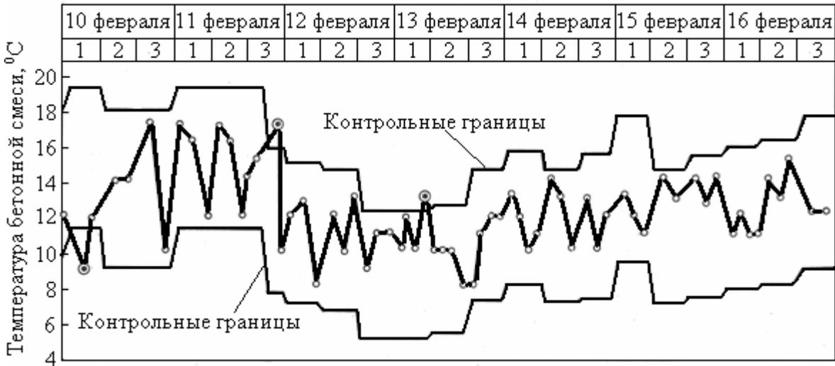
Рис. 5. Контрольная карта индивидуальных значений температуры бетонной смеси
