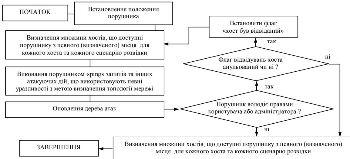
Рис. 2. Алгоритм формування дерева атак для визначеного положення порушника
