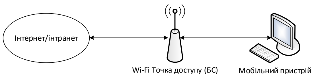
Рис. 6. Загальна архітектура технології Wi-Fi
