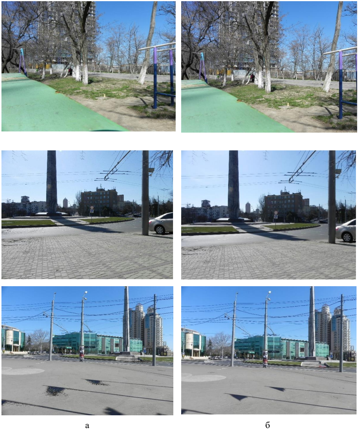
Рис. 5. Результати роботи розроблених алгоритмів видалення зайвих об'єктів: а – за допомогою усереднення зображень; б – за допомогою медіанного фільтру
