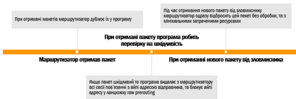
Рис. 4. Алгоритм обробки пакетів маршрутизатором з блокуванням шкідливого трафіку
