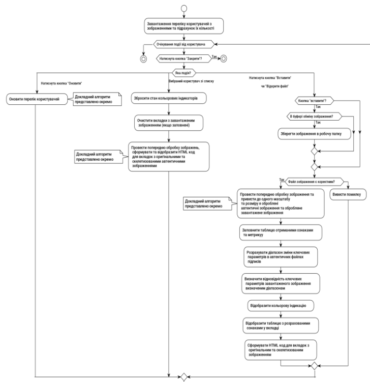
Рис.7. Алгоритм функціонування графічного інтерфейсу застосунку
